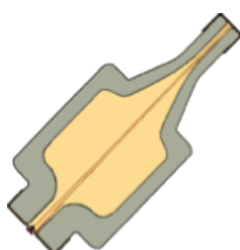
Afbeelding 1 Doorsnede zekering of smeltveiligheid.
